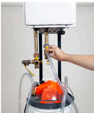
Brancher le tuyau de sortie à une vanne d'accès de l'appareil à détartrer.
